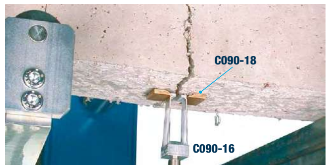
EN 14651 Clip gauge device
